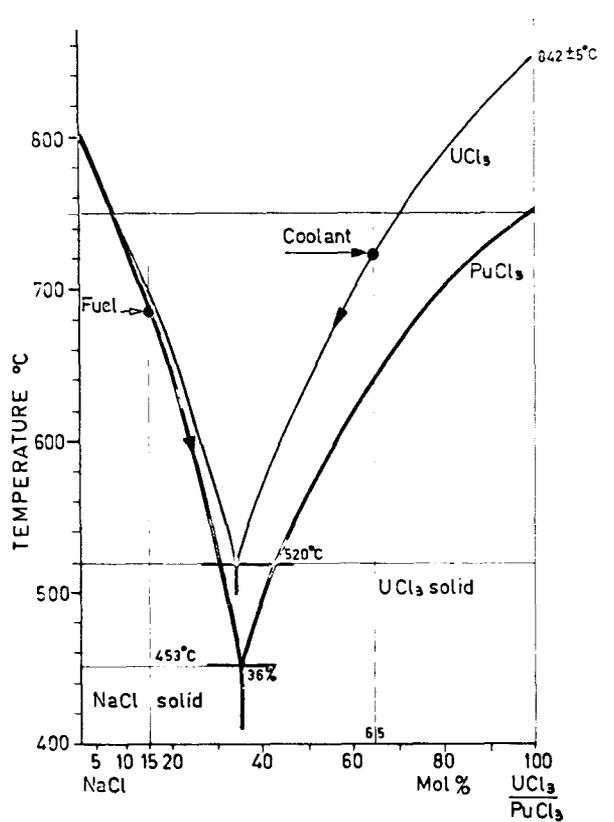
Fig. 6.9 The System  $\text{PuCl}_3\text{-NaCl-}\text{UCl}_3$
