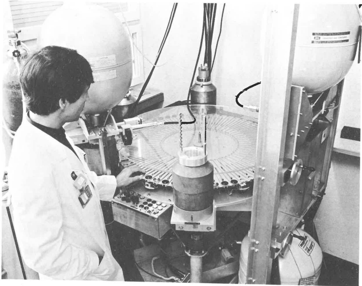
Bild 4 : Ausmessung bestrahlter Folien.
