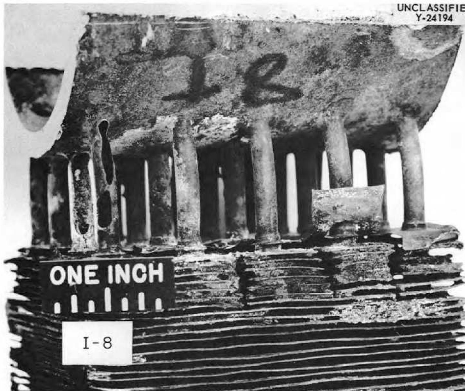
Fig. 3.6.12. Fire Damage in Section I-8.
