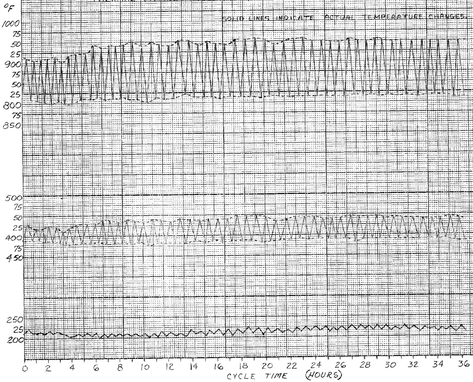
THERMAL CYCLING TEST OF FLANGE TFS TO FLANGE B LOWER 7-19-20
