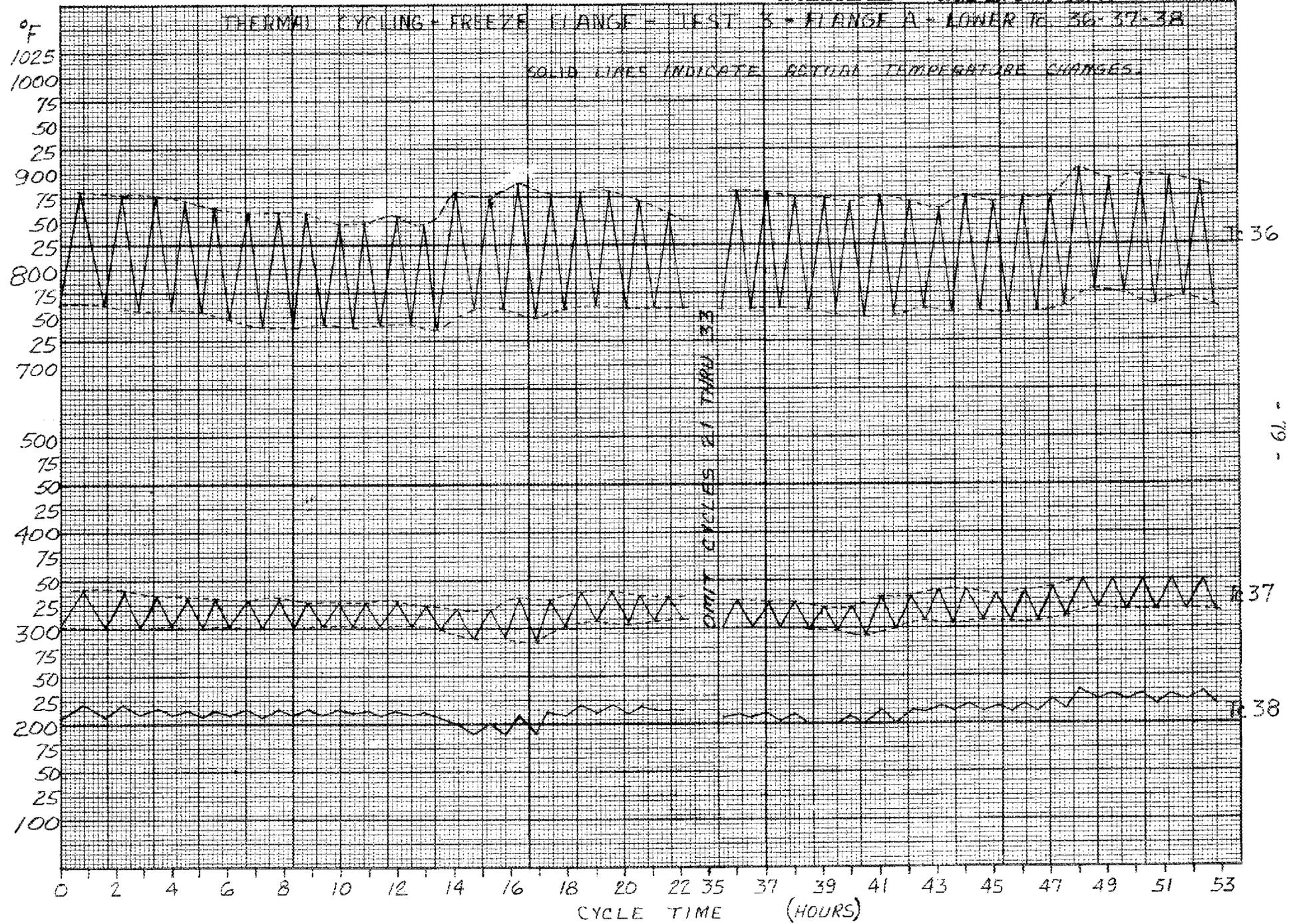
THERMAL CYCLING - FREEZE FLANGE - TEST 3 - FLANGE B - TOP TC 27-28-29
