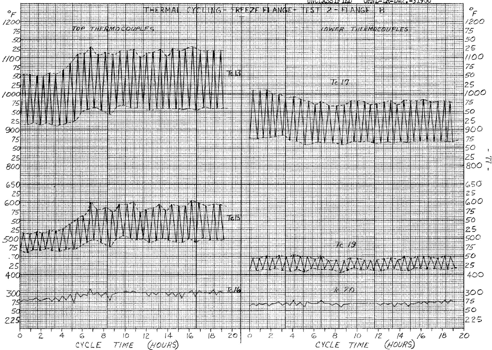
HEAT TREATING - FREEZE FLANGE - TEST 3 - FLANGE A - TOP W. 33-34-35
