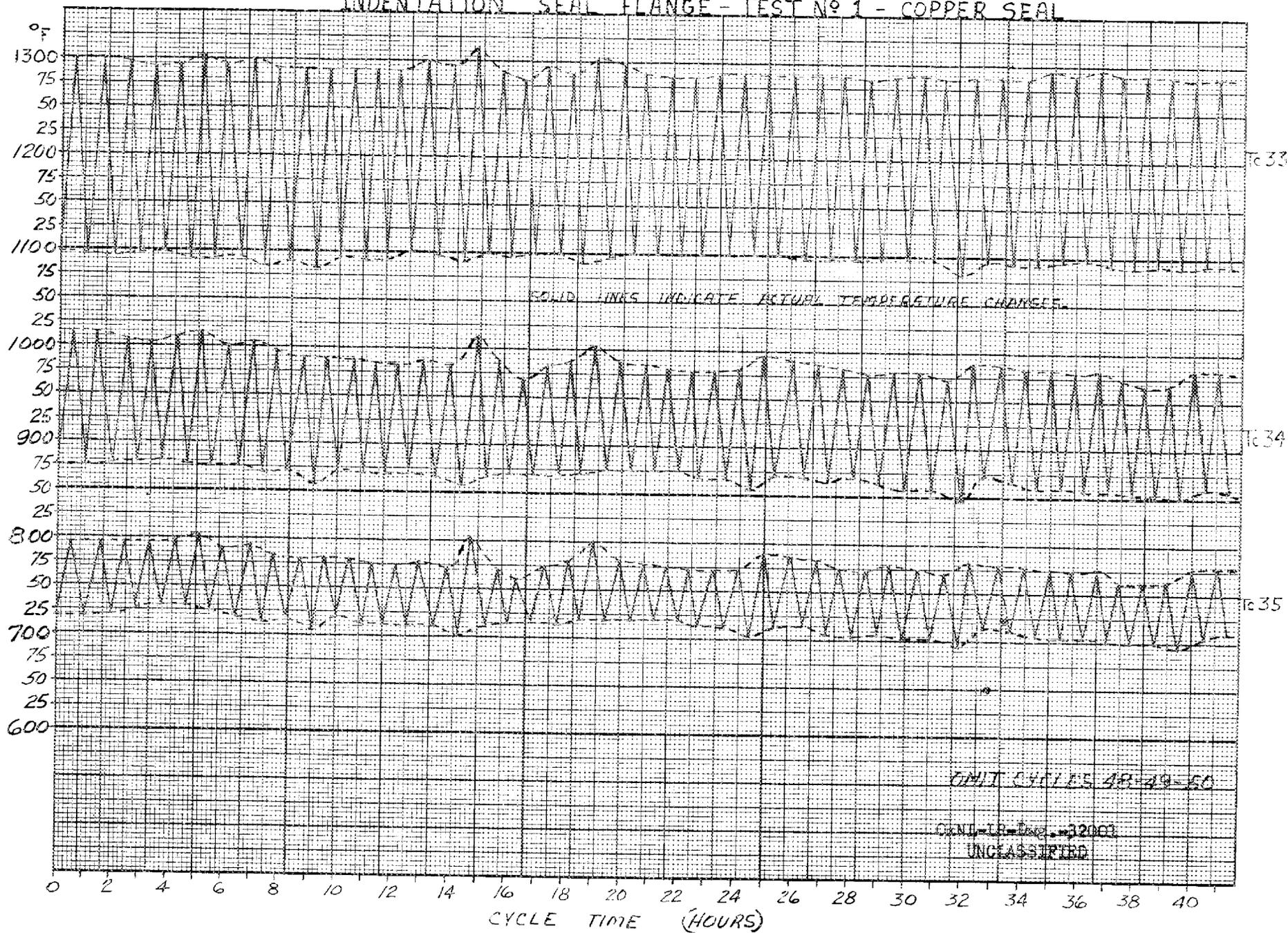
INDENTATION SEAL FLANGE - TEST NO 1 - COPPER SEAL
