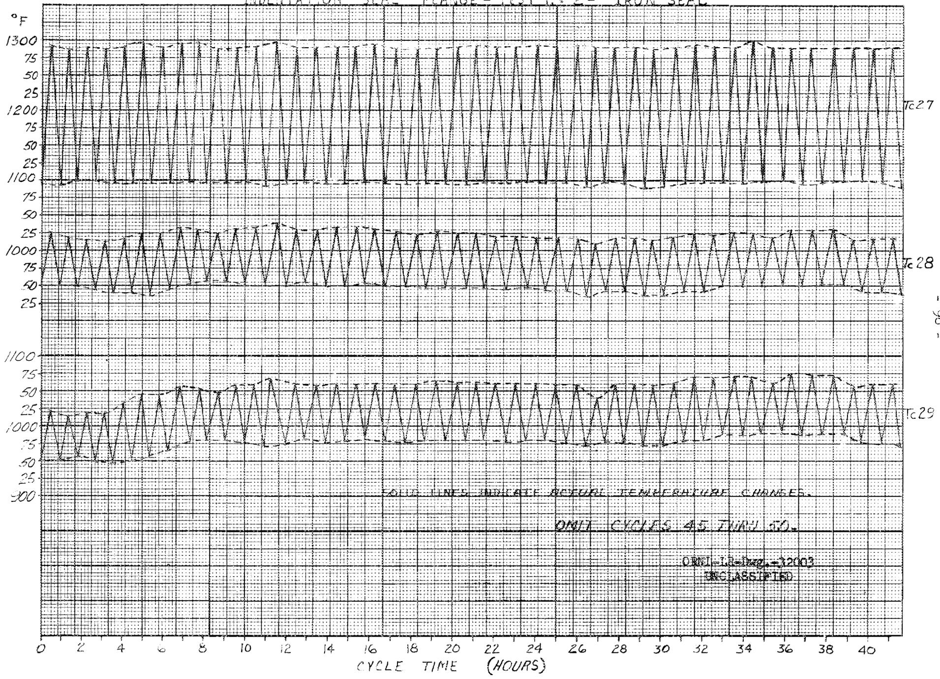
INDENTATION SEAL FLANGE - TEST N°2 - IRON SEAL
